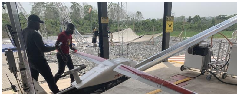
Préparation au catapultage d'un drone
